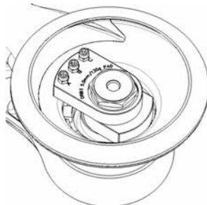
2. Διαμόρφωση μηχανήματος για χρήση με προστατευτικό πέλματος ή συνδετικό.
